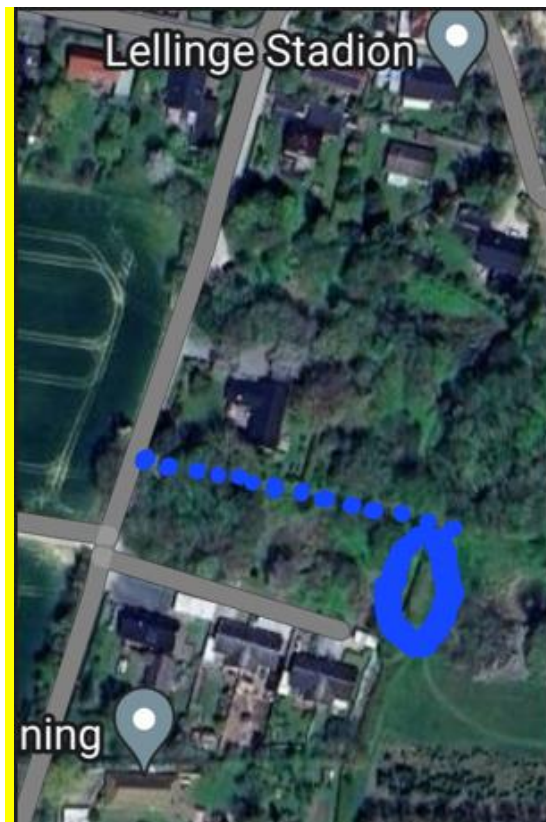
Figur 4 Den stiplede, blå streg er adgangsvejen til tømning af sandfanget med indkørsel fra Overdrevsvejen
