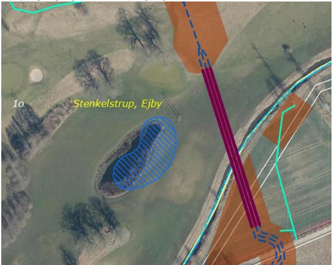
Figur 4. Køge Å. Kabeltracé er vist med mørkeblå stiptet line, arbejdsbæltet er vist med brun og adgangsvej med turkis linje. Styret underboring er vist med lilla linje.
