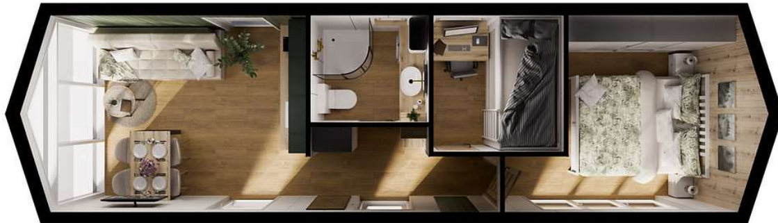
Billede 1: Eksempel på mobilehome med målene længde 11 m x bredde 3,45 m x højde 4 m.
